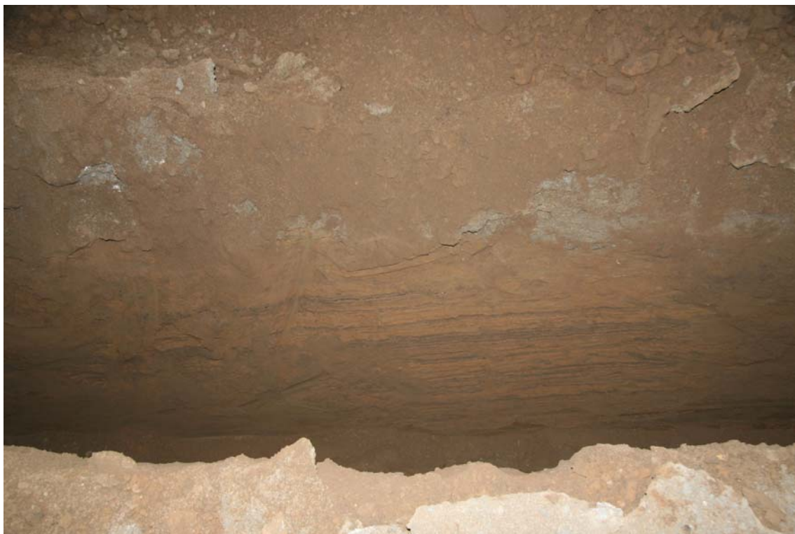
Mynd 4. Dæmi um jarðlagaskiptingu í skurðinum. Efst glyttir í gráan ofaniburðinn og þar undir skiptast á regluleg lög af fokmold, foksandi og gjóskulögum (GÓL-2007-25-9).
