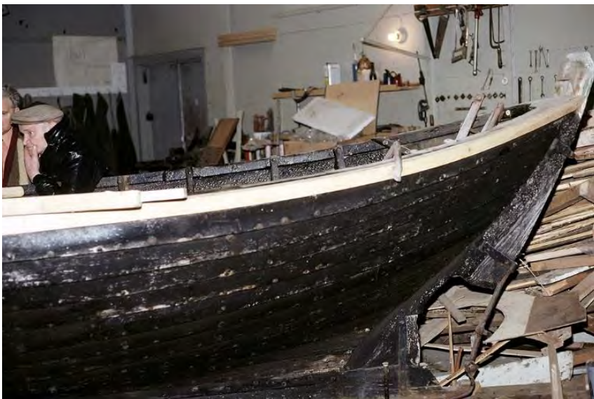
Bliki í viðgerð á Akranesi 1978. Hér sést greinilega að báturinn var með afturstefni fyrir vélbát. Ljós. Þjóðminjasafn Íslands, Skg-4072.
